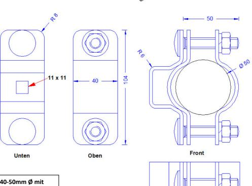
Für Maste 40-50mm Ø mit einer maximalen Höhe von 5,5m (zwei Schellen für einen Mast).
